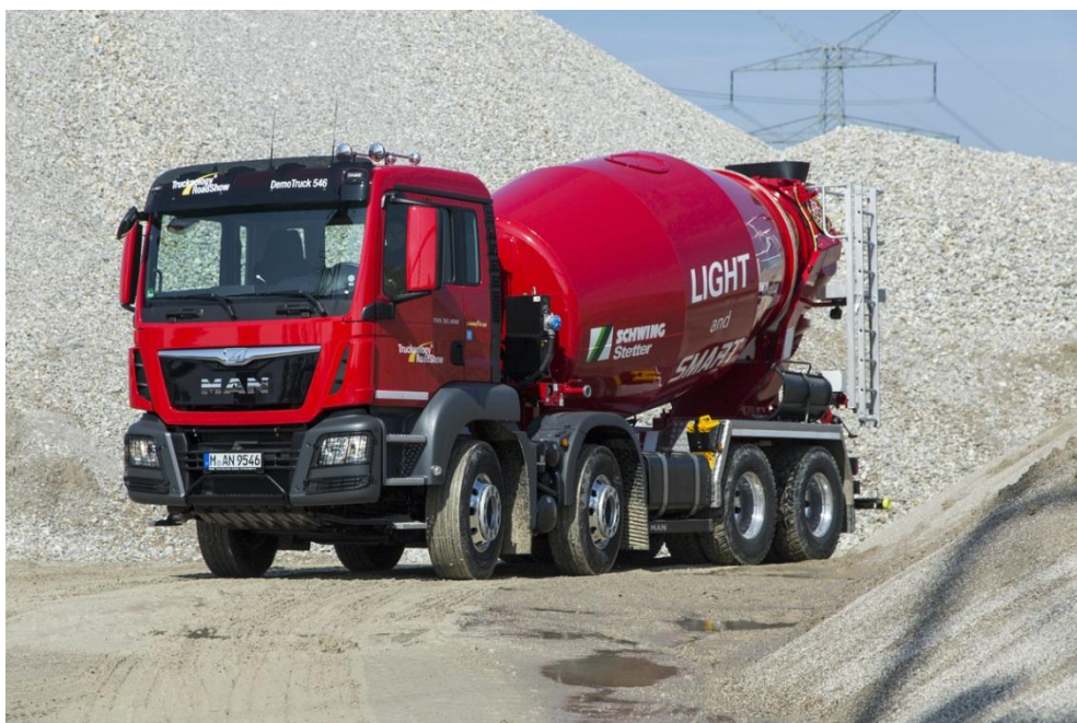
Ein Klassiker am Bau: der MAN TGS 32.400 8x4 BB als Betonmischer
